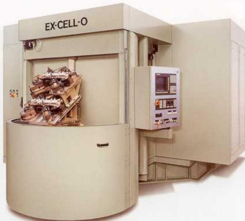
Neue Dimensionen der Bearbeitungsgeschwindigkeit erreicht EX-CELL-O jetzt mit dem Einsatz elektrischer Direktantriebe mit Linearmotoren für die 3 Hauptachsen X, Y und Z. So können die Eilganggeschwindigkeiten von 30 auf jetzt 80 m/min erhöht werden. Da durch große Beschleunigungs- und Verzögerungswerte auch kürzeste
